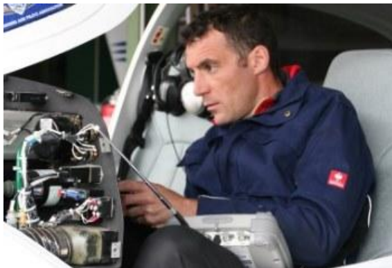
Wichtiger Bestandteil der Prüfung ist der Funktionstest der Avionik, wie hier durch John Mooney.
