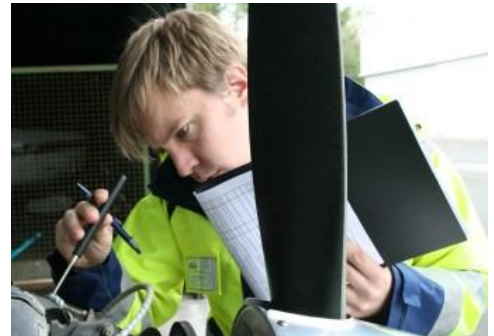
Zur Kontrolle von unzugänglichen Stellen, wie hier am Motorblock, verwendet Lasse Krutschinna den Teleskopspiegel.
